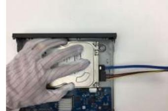
3. Alinee los tornillos del HDD con los agujeros en la parte posterior del dispositivo.
