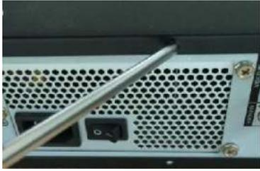
1. Retire los tornillos de la cubierta.
