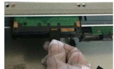
3. Conecte un extremo del cable del HDD al HDD.
