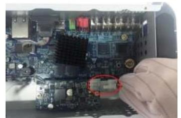
6. (Opcional) Tire del cable de la batería a través del orificio para conectarlo al puerto del cable.
