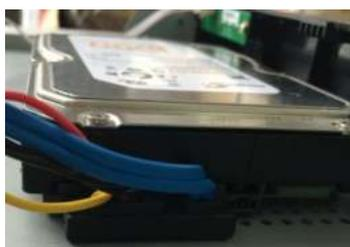
5. Use el cable HDD y el cable de alimentación para conectar
