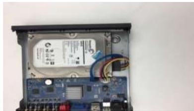
5. Conecte el cable del HDD y el cable de alimentación a la placa base.
