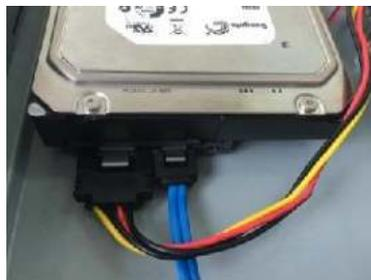
5. Use el cable HDD y el cable de alimentación para conectar el HDD y la placa base.
