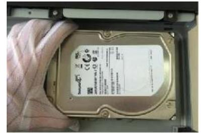
3. Coloque el HDD en el dispositivo.
