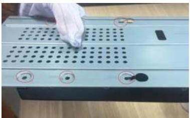
4. Haga coincidir los orificios en el soporte con los orificios para tornillos en el HDD.
