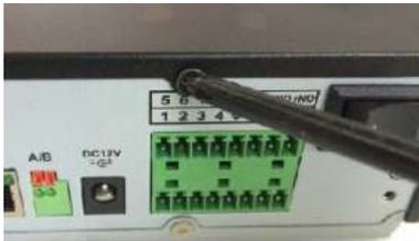
1. Retire los tornillos de la cubierta.
