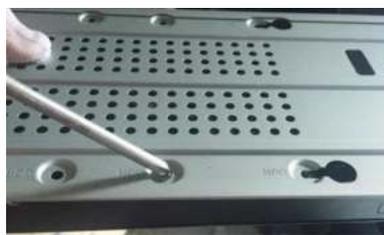
5. Use tornillos para fijar el HDD en el soporte.
