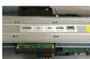
5. Use el cable de alimentación para conectar el HDD y la placa base.
