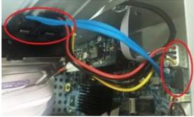
7. Use el cable HDD y el cable de alimentación para conectar el HDD y la placa base.
