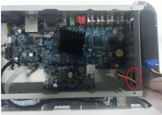
1. Tire del cable de la batería a través del orificio.
