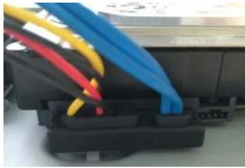
5. Use el cable HDD y el cable de alimentación para conectar el HDD y la placa base.
