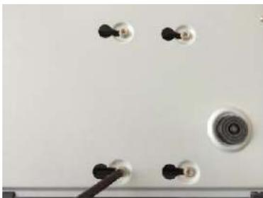
4. Gire el dispositivo para ver su parte posterior. Alinee los tornillos del HDD con los agujeros en la parte posterior del dispositivo y luego fije los tornillos.
