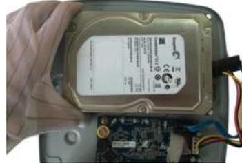
3. Haga coincidir los tornillos con los agujeros en el DVR para colocar el HDD.
