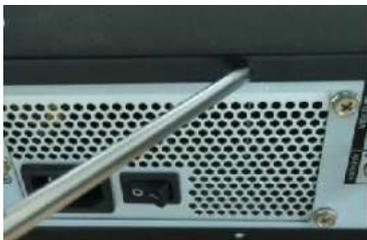
1. Retire los tornillos de la cubierta.
