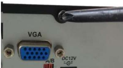
1. Retire los tornillos del panel posterior.
