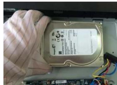
3. Coloque el HDD en el dispositivo.
