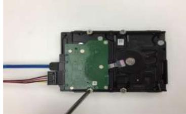
2. Conecte el cable del HDD y el cable de alimentación al HDD, y apriete los tornillos en el HDD.
