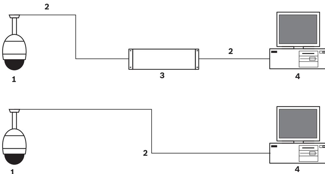
Figura 11.1: Configuración del sistema de la AUTODOME IP
