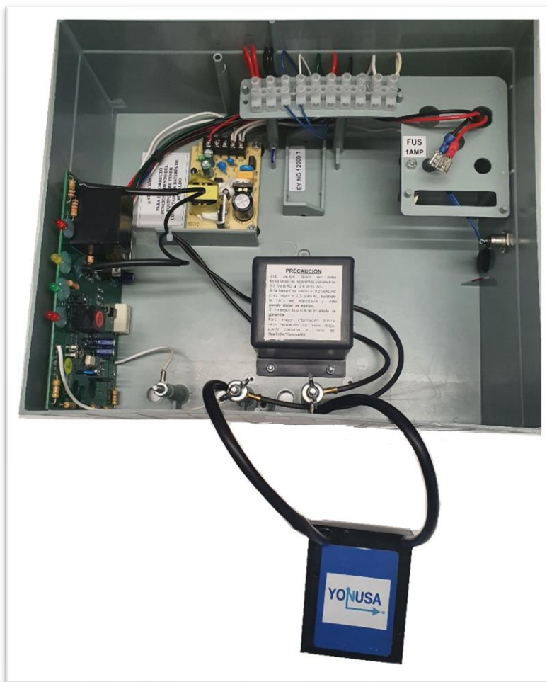
Figura 1. Diagrama de conexión entre un energizador AF y la tarjeta anti-inducción- Amplificador de potencia.
