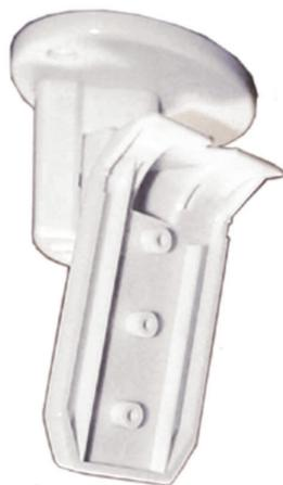
Permite montar en superficie detectores en el techo. El rango de giro vertical es de +7° a -16°; el rango de giro horizontal es de  $\pm 45^\circ$ . No lo utilice para aplicaciones con mascotas
